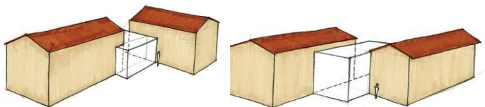
Exemples de volume de jonction entre bâtiments
